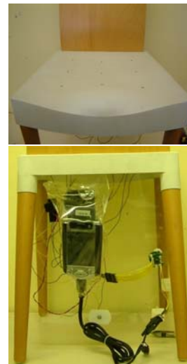
Σχήμα 15.2 Μερικά από τα πρώτα Τεχνουργήματα: μιά κούπα και μια καρέκλα με Αισθητήρες (η κομψότητα θυσιάστηκε υπέρ της λειτουργίας)
