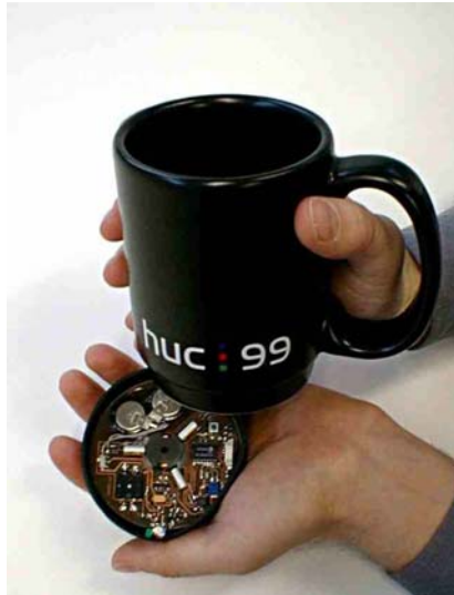
Σχήμα 15.2 Μερικά από τα πρώτα Τεχνουργήματα: μιά κούπα και μια καρέκλα με Αισθητήρες (η κομψότητα θυσιάστηκε υπέρ της λειτουργίας)
